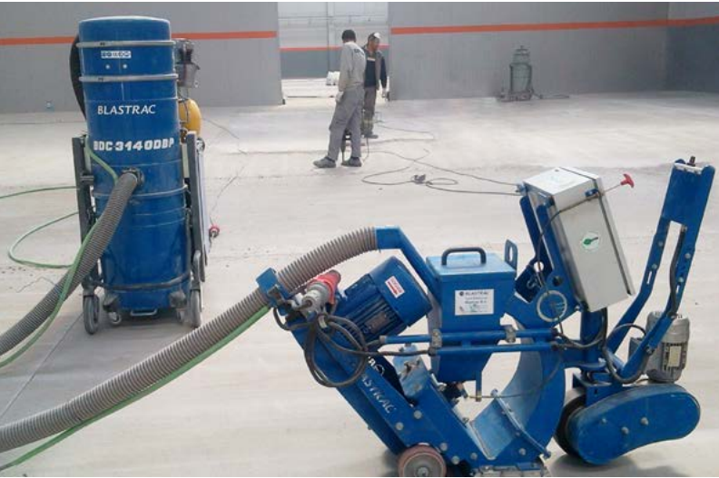
EPOKSİ POLİÜRETAN ZEMİN KAPLAMA YÜZEY HAZIRLAMA MAKİNALARI
